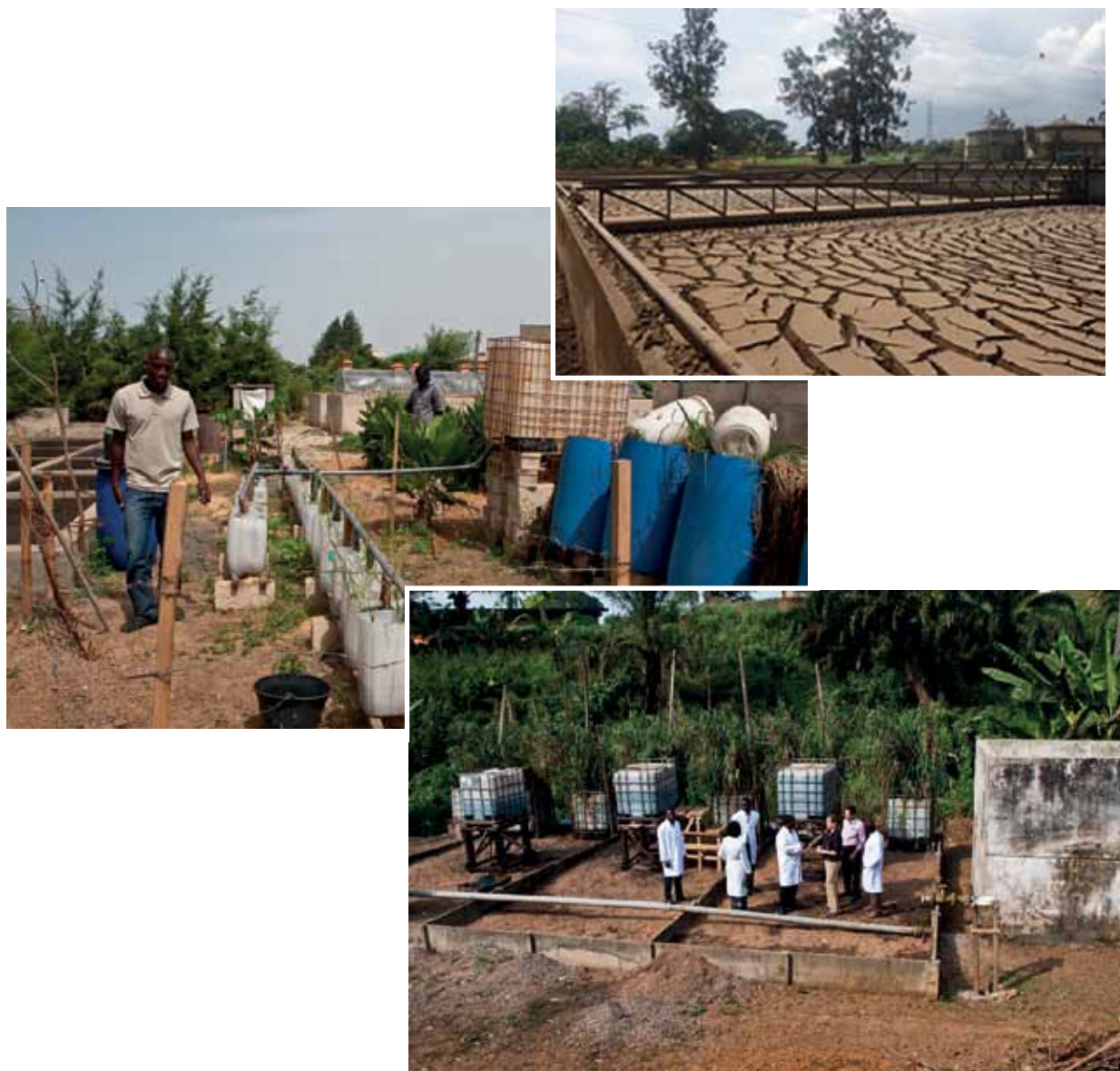
Figura 18.5 Investigación acerca de los lechos de secado: aparato para mezclar los lodos en lechos de secado sin plantas en la estación depuradora de aguas residuales Bugolobi en Kampala, Uganda (arriba) un estudio de posibles especies de plantas para sembrar en lechos de secado en Dakar, Senegal; y un proyecto piloto de lechos de secado con plantas para tratar los lixiviados de otros lechos de secado, en Yaoundé, Camerún (fotos: Linda Strande).
