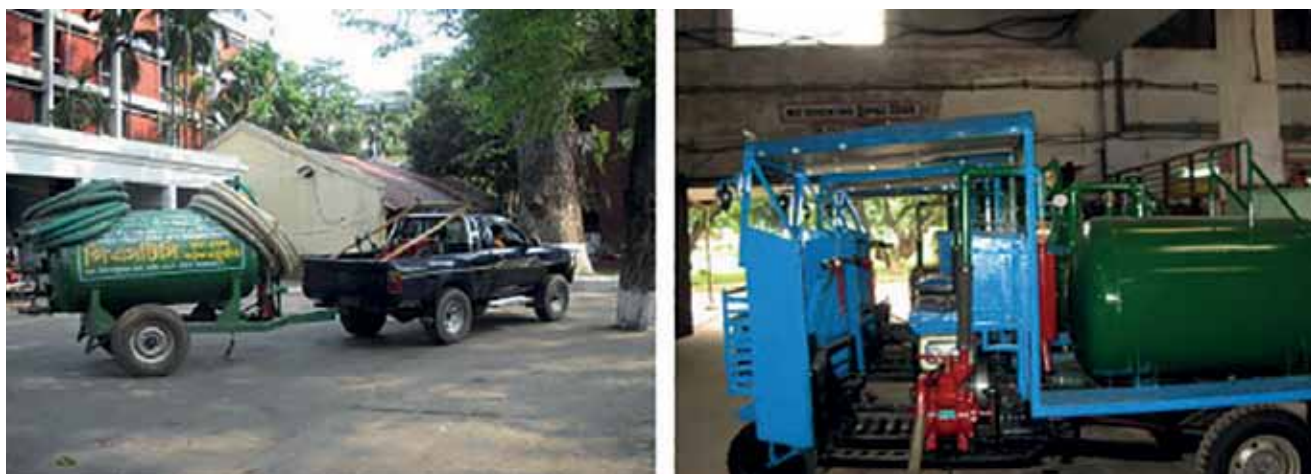
Figura 4.11 Los modelos Mark III (izq.) y Mark IV (der.) de BREVAC, aparatos para succionar y transportar lodos fecales (foto: Peter Edwards).
