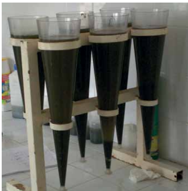
Figura 6.4 Análisis del índice del volumen de los lodos (SVI) con conos Imhoff (foto: SANDEC).
