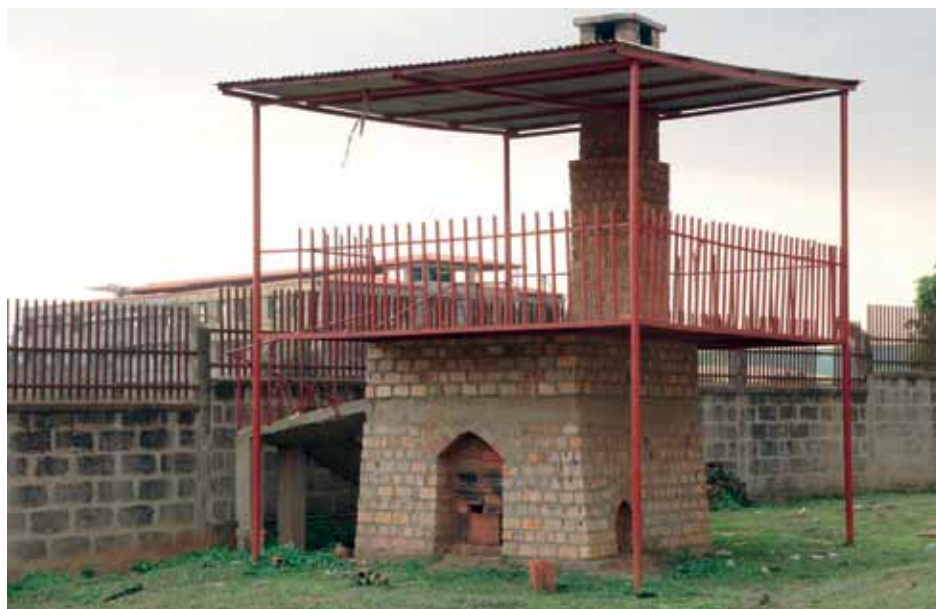
Figura 18.6 Horno en tamaño piloto del proyecto FaME (Emprendimientos para Manejo Fecal) para la co-combustión de lodos fecales en la producción de ladrillos en Kampala, Uganda (foto: Pitman Ian Tushemeziwe)
