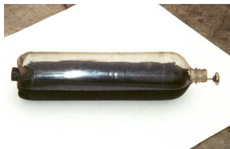
Botella de gaseosa con monitor de temperatura
