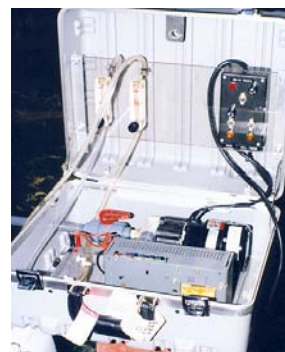
Equipo de producción de hipoclorito dentro de una corriente de agua
